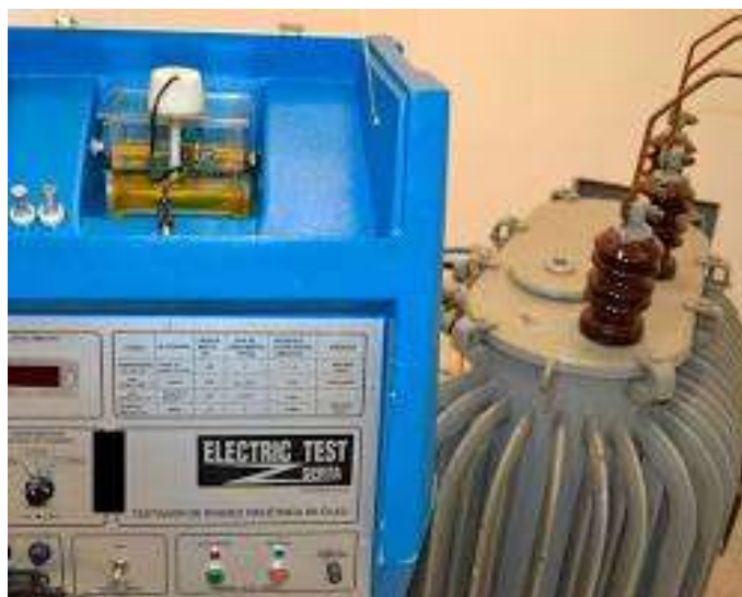
Figura 20 - Teste de resistência dielétrica - www.mediavoltagem.com.br
